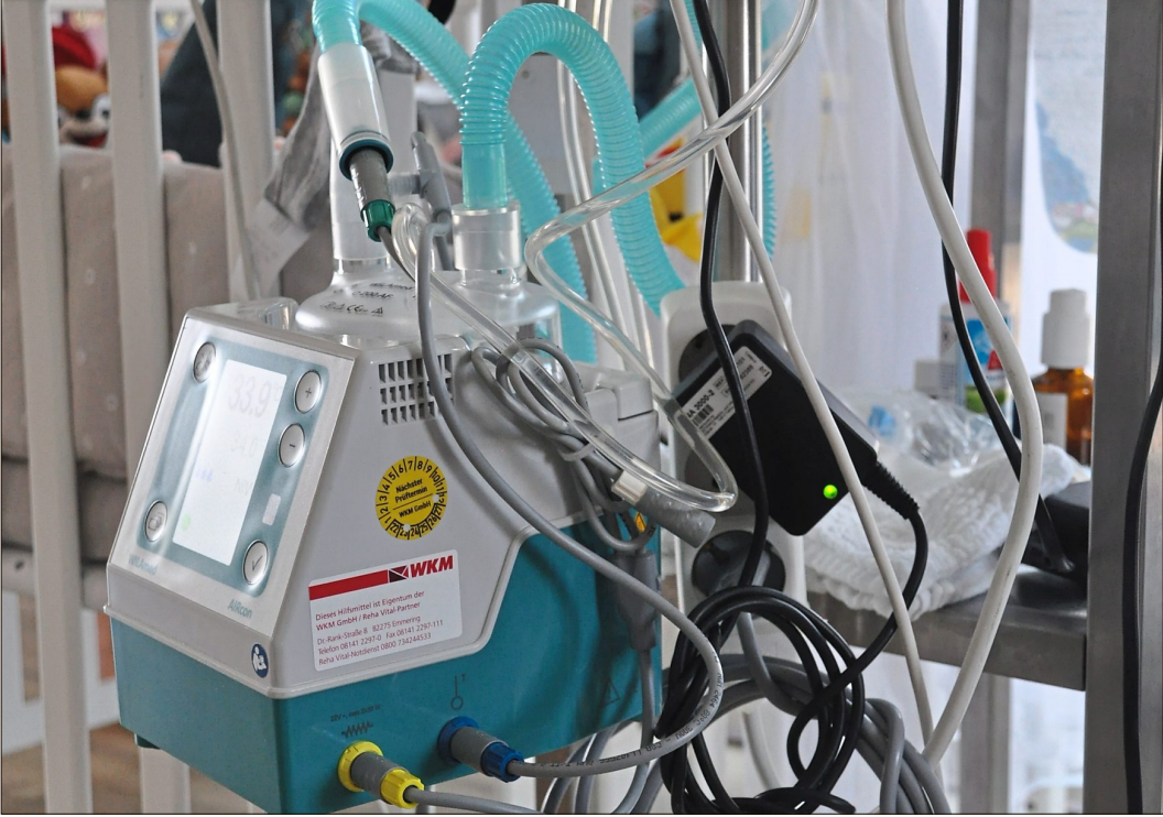
Luft zur Atemunterstützung: Der Apparat versorgt Theresa mit elf Litern angewärmter Raumluft über Schläuche, die in die Nase führen.
